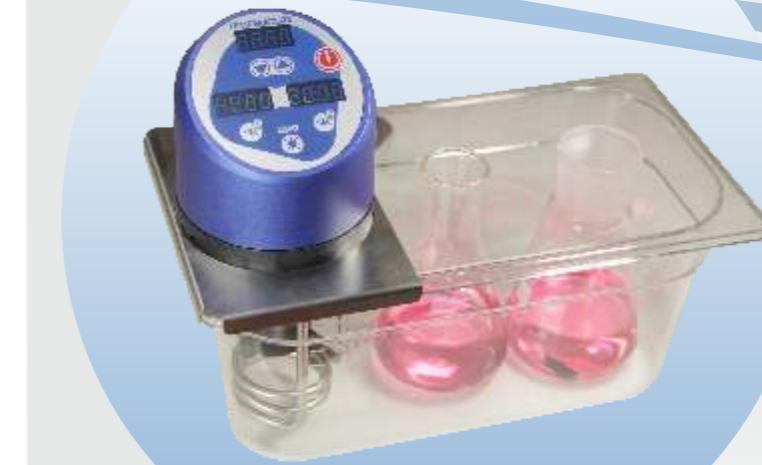
Конструкция водяного термостата TW - 2 состоит из цельнолитой ванны объемом 4,5 л. и термоблока с микропроцессорной системой управления, обеспечивающей следующие параметры.
